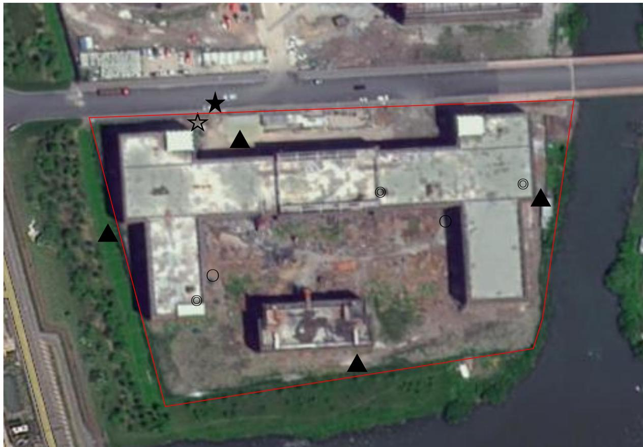
★-废水采样点；☆-雨水井收集水采样点；▲-工业企业厂界噪声检测点；◎-有组织废气监测点；○-无组织废气监测点
